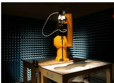
图 25 DASY-4 测试系统
