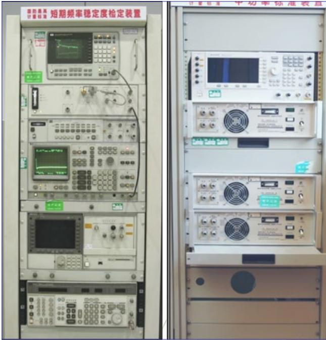
图 2 短期频率稳定度检定装置及中功率标准装置
