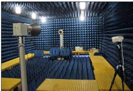
图 11 微波暗室 - 卫星导航产品功能及性能检测
