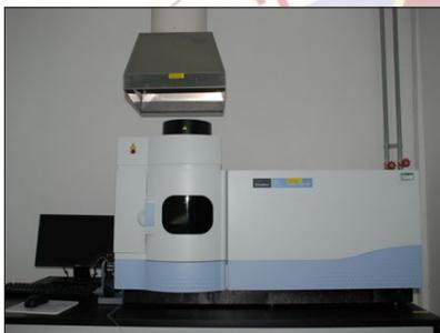
图 23 等离子体电感耦合发射光谱仪
