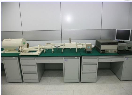
图 3 10cm 热噪声基准装置
