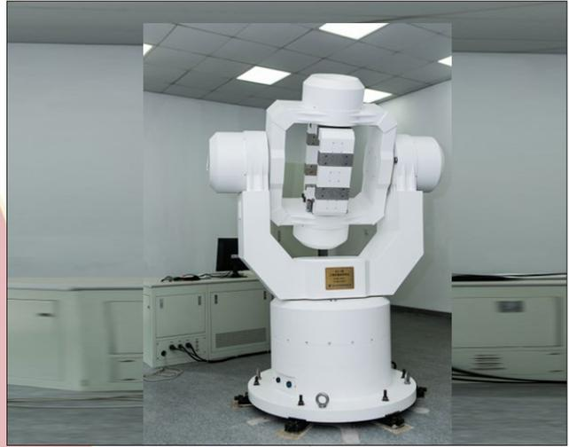
陀螺仪检测校准装置
