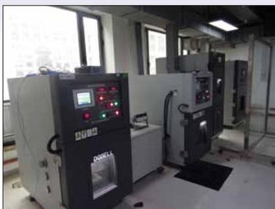
图 21 电池爆炸测试系统
