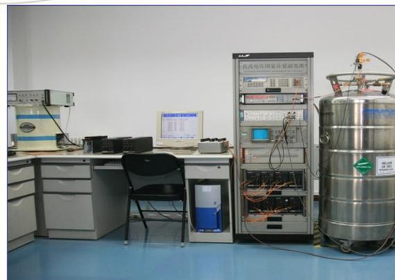
图 4 直流电压国家计量副基准
