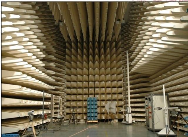
图 17 微波暗室—电磁兼容检测
