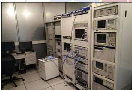
图 5 多体制卫星导航互干扰测试系统
